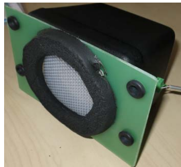
Abb. 17a. SP10 mit Montageplatte, Verbindungsstecker, Kabel
