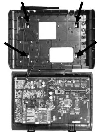
Abb. 12. Offene Basisstation mit den vier Schraubenlöchern
