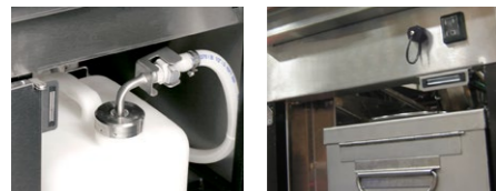
Automatische Ölnachfüllung aus der Nachfüllbox (JIB) bei mehreren Frittierbecken (links) bzw. aus dem Vorratsbehälter bei einem Frittierbecken (rechts)
