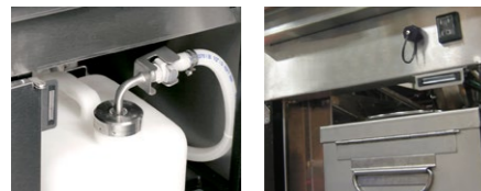
Automatische Ölnachfüllung aus der Nachfüllbox (JIB) bei mehreren Frittierbecken (links) bzw. aus dem Vorratsbehälter bei einem Frittierbecken (rechts)
