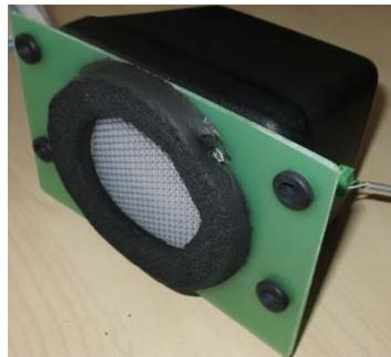
Abb. 17a. SP10 mit Montageplatte, Verbindungsstecker, Kabel
