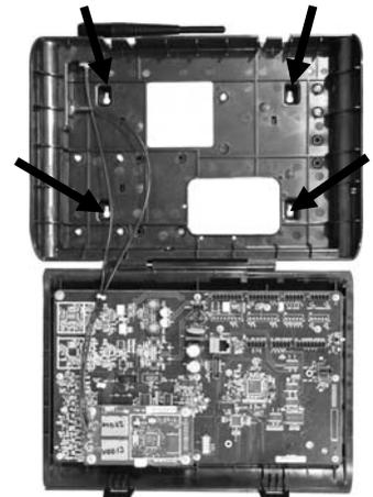
Abb. 12. Offene Basisstation mit den vier Schraubenlöchern
